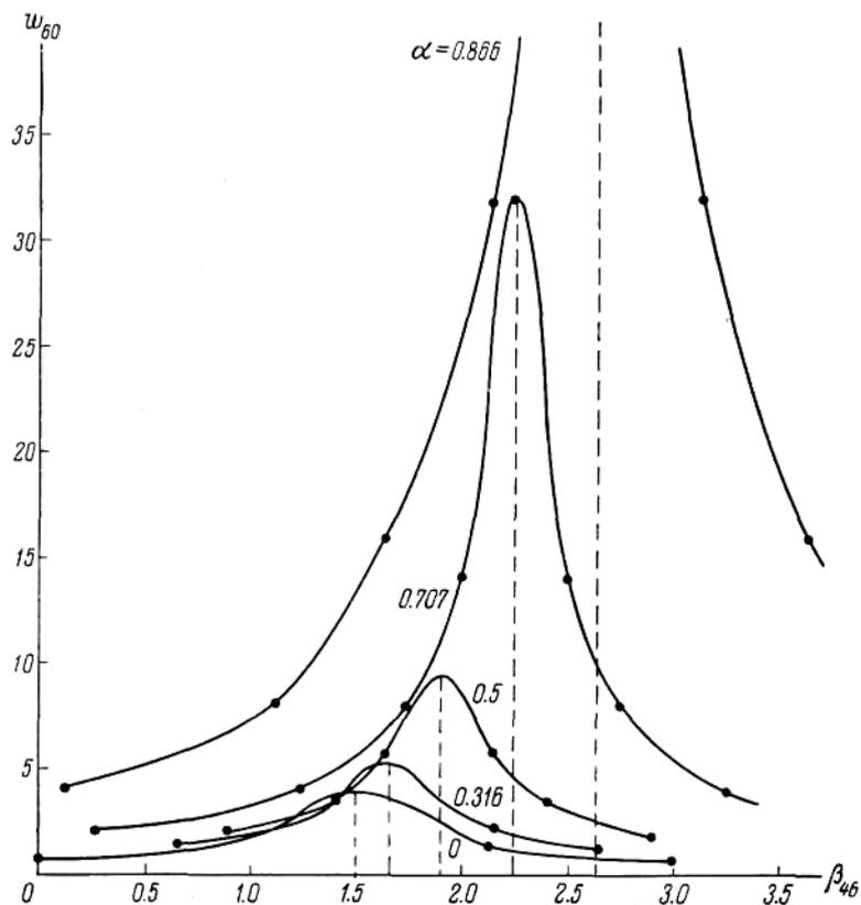
Рис. 2. Зависимость остаточной волновой абберации пятого порядка  $w_{60}$ , обеспечивающей маршалевский допуск  $\lambda^2 / 180$ , от формы коррекции  $\beta_{46} = -\omega_{40} / \omega_{60}$  при различных величинах центрального экранирования  $\alpha$ , при оптимальном выборе плоскости установки.
