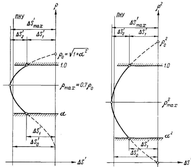
Рис. 1. Продольная сферическая абберация и положение плоскости наилучшей установки (ПНУ) при оптимальной коррекции на минимум в случае центрального экранирования  $\alpha$ .
