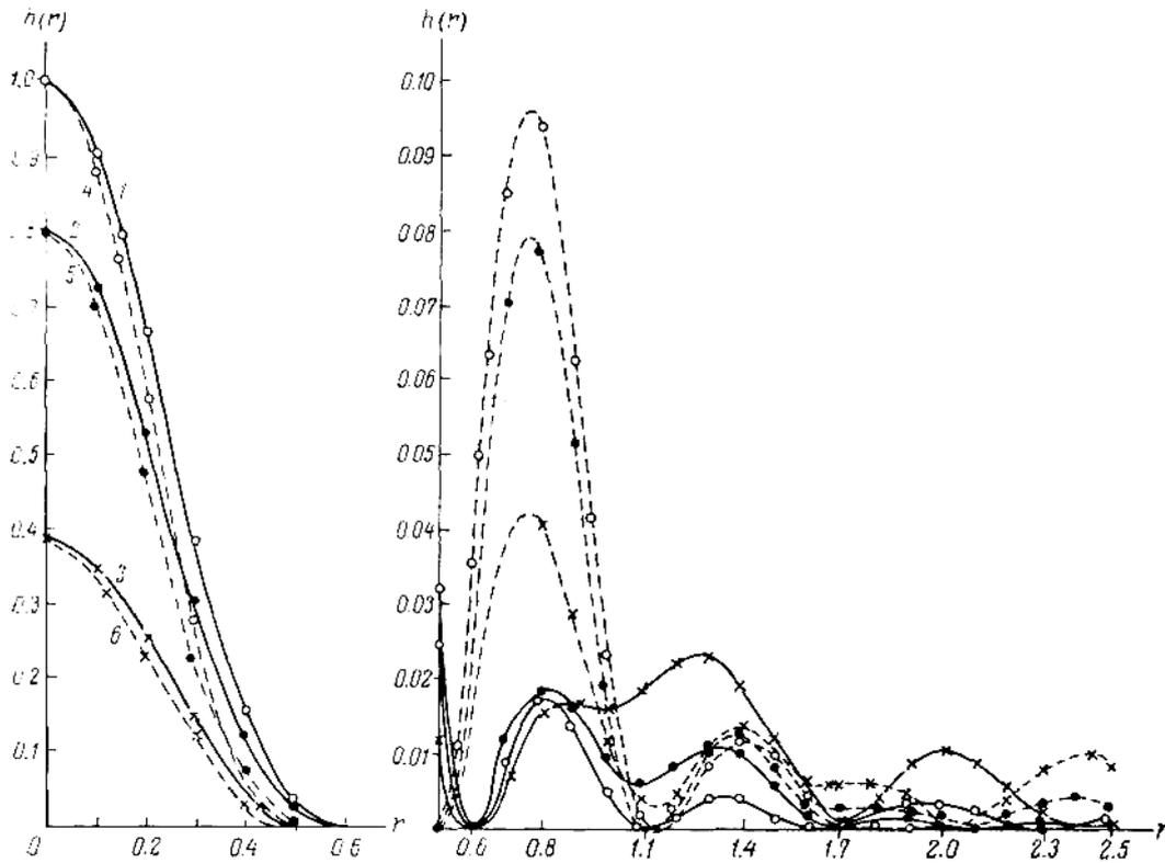
Рис. 3. Кривые распределения интенсивности в дифракционном изображении точки  $h(r)$  при различных значениях коэффициента центрального экранирования и различных абберациях ( $r$  – в оптических единицах).
