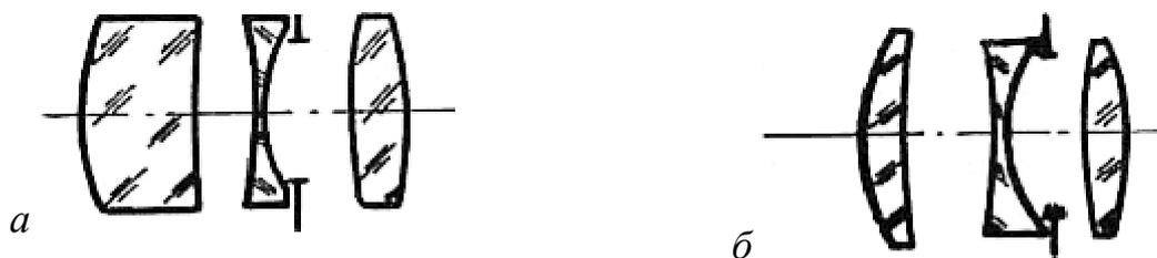
Рис. 1. Схема оптики объектива «Триплет»:  $f'_0 = 67 \text{ мм}$  1:3  $2\beta = 20^\circ$ : а – исходная система; б – результат оптимизации
