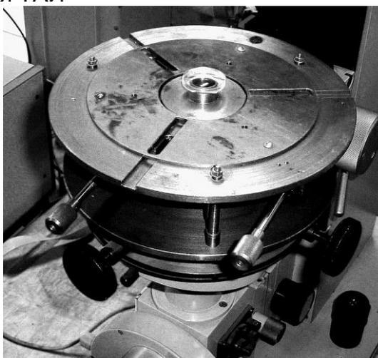
Рис.3. Контроль линзы на интерферометре Физо
