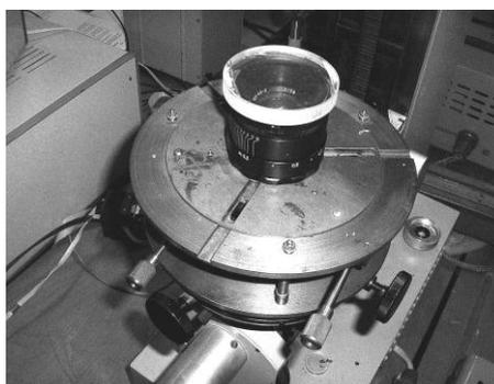
Рис.7. Контроль объектива Гелиос-44 на интерферометре Физо
