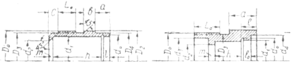
Рис 35. Оправы пятилинзового окуляра
